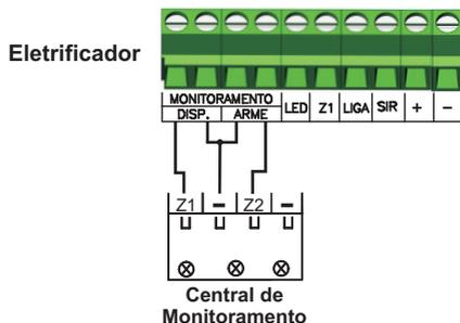
Obs: Para a ligação do eletrificador em um painel monitorável, deve-se utilizar o resistor de fim de linha (que acompanha o painel monitorável)
