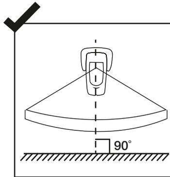
3- Instalar manteniendo la perpendicularidad con el suelo.
