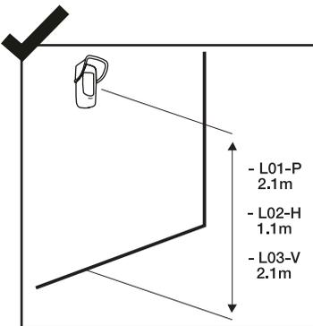
1- Respetar la altura de instalación del sensor indicada para cada lente.
